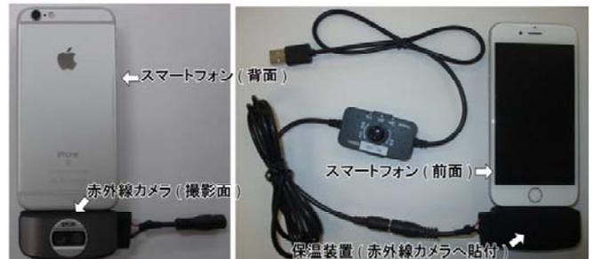
写真-3 実験に用いた赤外線カメラ
