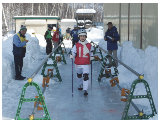
写真-3 実験状況(氷板, 冬靴+ポール+スパイク)
